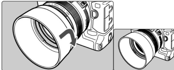
Бленда ES-78 не допускает нежелательные блики и свет на линзы объектива, а также защищает объектив от попадания на поверхность линзы дождя, снега и пыли.
