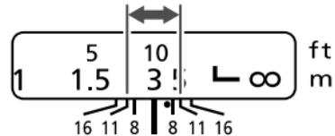
Глубина резкости – это диапазон пространства (расстояния) спереди и сзади плоскости фокуса на объекте, которое изображается резким. Глубина резкости обозначается зоной между линиями на шкале глубины резкости под шкалой расстояний. Цифры на шкале даны в значениях F, и, например, при съемочном расстоянии 3 м и диафрагме f/11 зона резкости занимает диапазон пространства от 2 м до 5 м.
