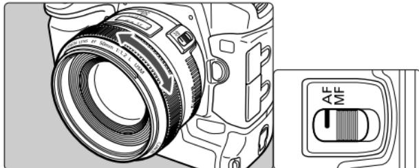
Для съемки в режиме автоматической фокусировки (AF) установите переключатель режимов фокусировки в положение AF.
