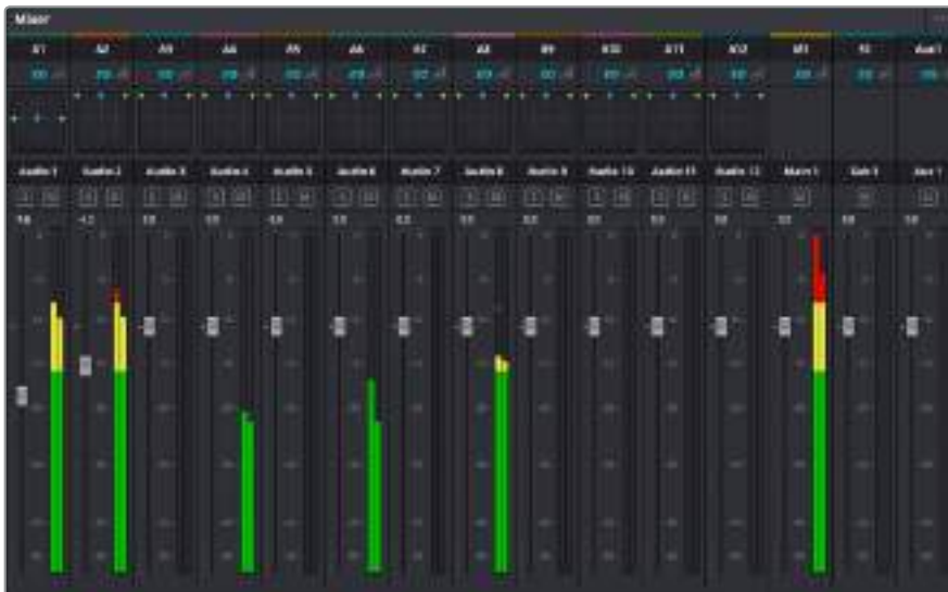
Il mixer audio, con le strisce di canale corrispondenti alle tracce nella timeline
