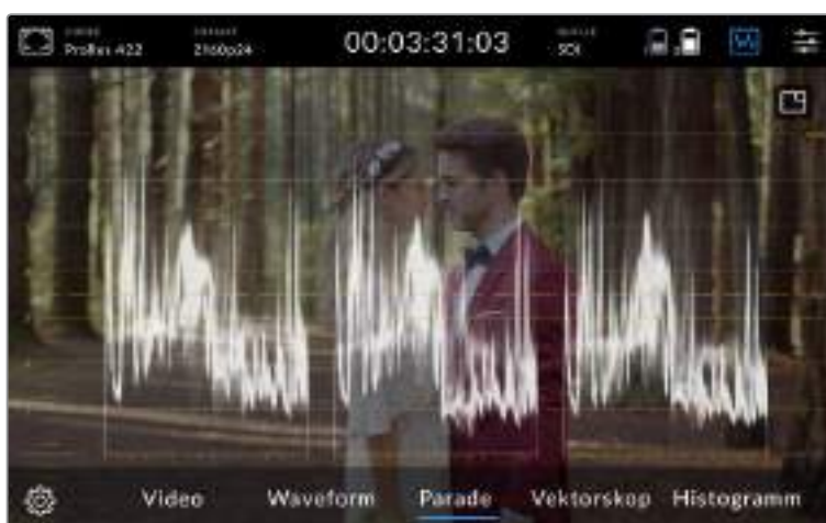
Die RGB-Parade stellt die Luminanz des roten, grünen und blauen Kanals in Wellenformen dar
