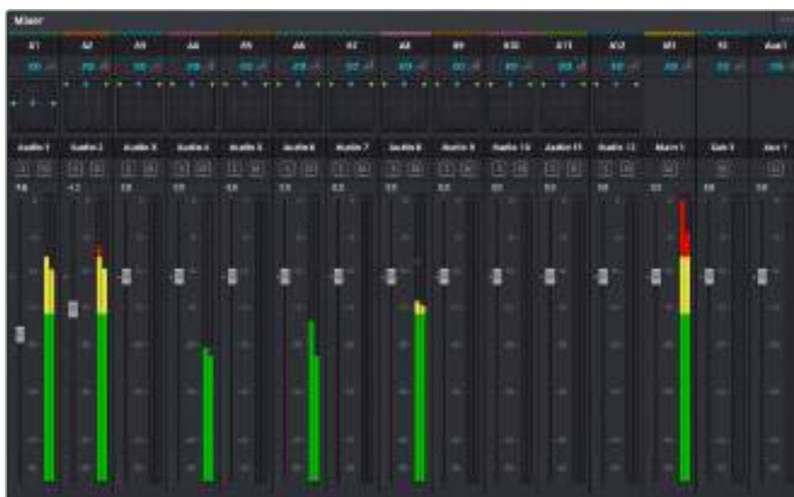
图为调音台, 其多个通道条分别对应的是时间线上的多个轨道。
