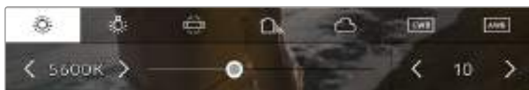
Toucher les indicateurs de balance des blancs et de teinte de la Blackmagic Pocket Cinema Camera 4K vous permet d'accéder aux cinq pré-réglages, au curseur de la balance des blancs et à l'indicateur de teinte. Vous pouvez régler ces icônes pour personnaliser la balance des blancs en fonction des conditions d'éclairage.
