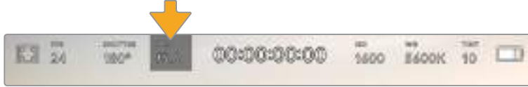
Blackmagic Pocket Cinema Camera 4Kのアイリスインジケータ。 タップしてアイリス設定にアクセス。
