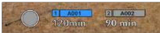
Индикатор носителя на Blackmagic Pocket Cinema Camera 4K показывает имя накопителя (CFast, SD или USB-C), а также оставшееся время записи в минутах
