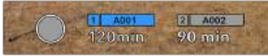
Blackmagic Pocket Cinema Camera 4K的存储卡提示可显示CFast卡、SD卡或USB-C存储盘的名称，并能以分钟显示剩余记录时间。
