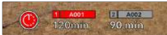
Blackmagic Pocket Cinema Camera 4Kは、録画ボタンの上にアイコンを表示して、タイムラプス撮影であることを表示します。
