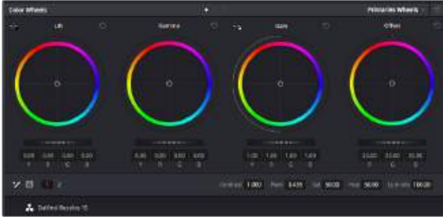
'Lift', 'gamma', 'gain' ve 'offset' renk tekerleri, kliplerinizin renk ve tonlama dengesi üzerinde tam kontrol sağlar. Her bir tonlama bölgesi için renklerin tümüne aynı ayarlamayı yapmak üzere, renk tekerlerinin altında bulunan kadransı, ileri ve geri sürükleyin.
