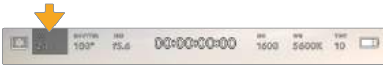
Blackmagic Pocket Cinema Camera 4KのFPSインジケータ。タップしてフレームレート設定にアクセス。
