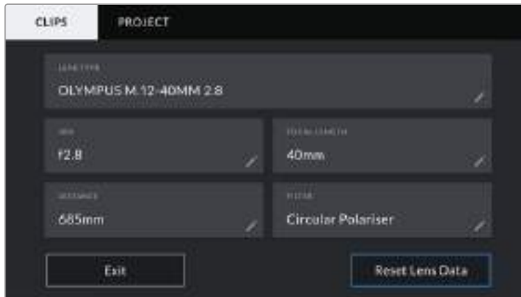
Panel con información obtenida automáticamente de un objetivo montado en la cámara y los datos del filtro introducidos de forma manual.
